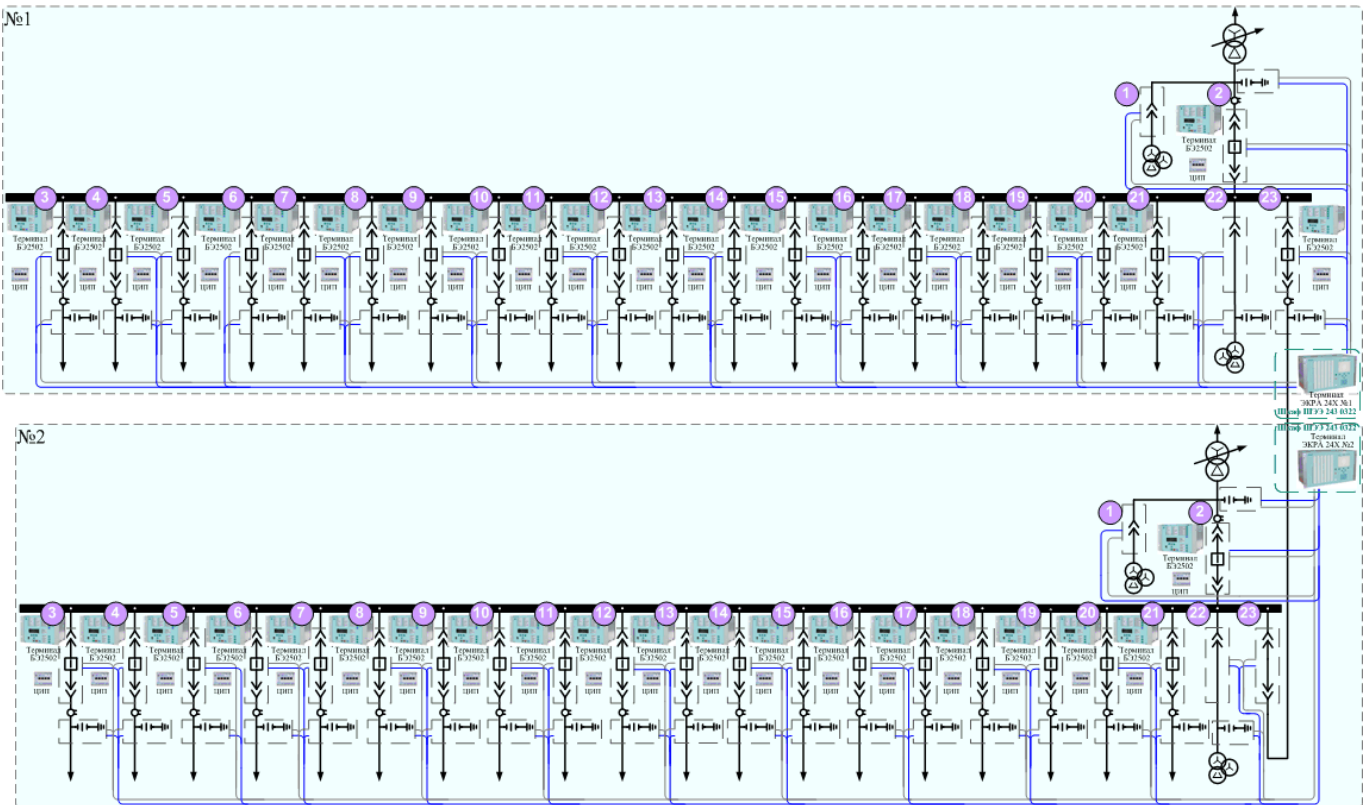
Пример использования ШЭЭ 243 0322 – один терминал на одну секцию шин
